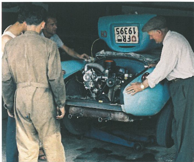
Installation av en MAG kompressor.
