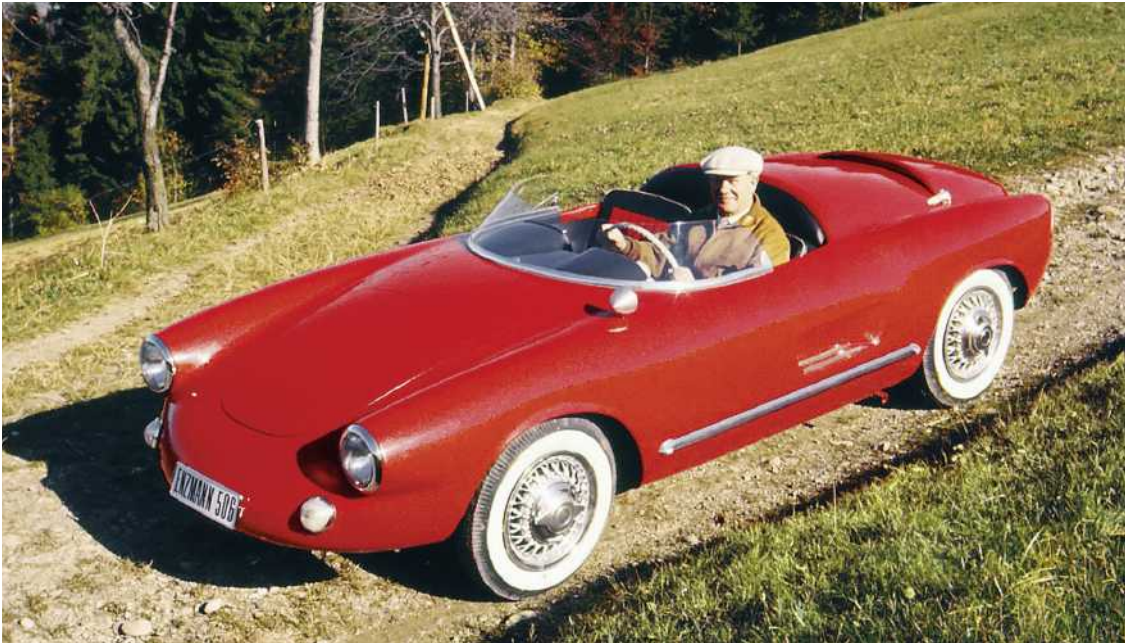
EMIL ENZMANN SEN. um 1956 am Lenkrad des ersten Prototyps; noch mit Spider-Scheibe und Speichenradkappen mit ange deuteten Zentralverschlüssen (oben). Der zweite weisse Prototyp an der IAA in Frankfurt 1957 mit den ursprünglich vorgesehenen, nicht zulassungsfähigen Heckleuchten (links) und Kartenhalter (Mitte). Prototyp Nr. 1 vor heimlicher Kulisse (rechts).
